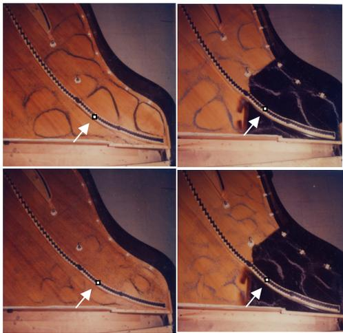
図 7 矢印で示す白点の真下で駆動したときのクラドニ法による響板の振動モード（左：通常の響板，右：カーボンファイバーシート強化響板，上：932Hz，下：1,864Hz）
