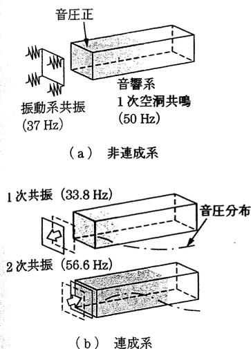
図 7.47 連成によるモードの変化
